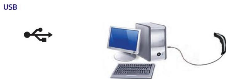
Čitalnik HERON™ HD3130 za uporabo v sistemu COBISS priklučimo na osebni računalnik preko vhoda USB.
